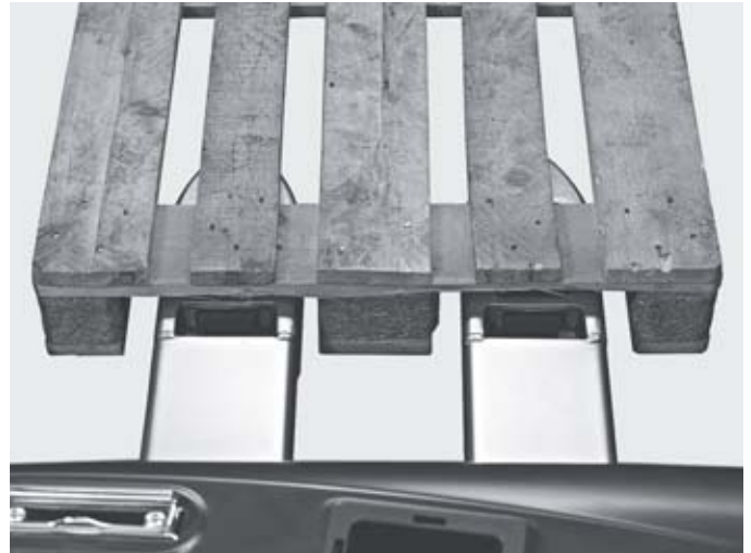
Visuale ottimale sulle punte delle forche per la rapida inforcatura dei pallet
